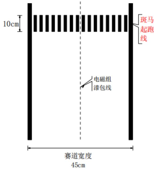
并且在起跑线处安装有永久磁铁。磁铁参数：直径 7.5 - 15mm，高度 1-3mm，表面磁场强度 3000--5000 高斯。安装方式如下示意图：
